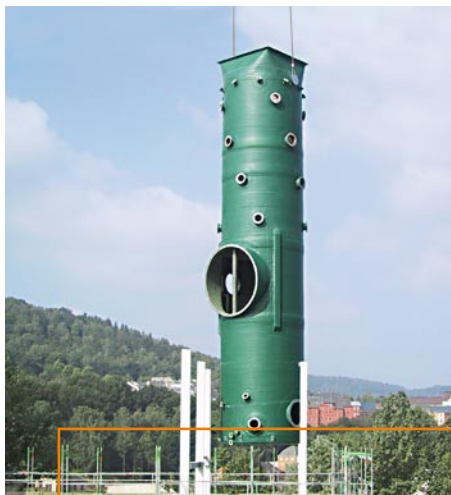
Prozess-Chemikalien umweltgerecht in den Griff bekommen, wie z. B. in der Nickelhütte Aue. Der Reich-Wäscher reinigt die bei der Verbrennung von Ne-metallhaltigen Schlämmen entstehenden Rauchgase aus der chemischen Industrie unter Zusatz einer Kalkstein-Suspension. Die Anlage trägt entscheidend dazu bei, dass die Chemie nicht zum Risiko für die Umwelt wird.
