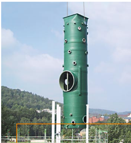
Prozess-Chemikalien umweltgerecht in den Griff bekommen, wie z. B in der Nickelhütte Aue. Der Reich-Wäscher reinholt die bei der Verbrennung von Ne-metallhaltigen Schlämmen entstehenden Rauchgase aus der chemischen Industrie unter Zusatz einer Kalkstein-Suspension. Die Anlage trägt entscheidend dazu bei, dass die Chemie nicht zum Risiko für die Umwelt wird.
